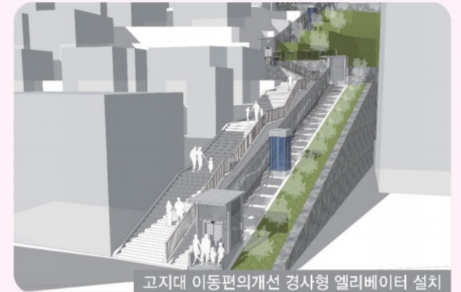
고지대 이동편의개선 경사형 엘리베이터 설치
